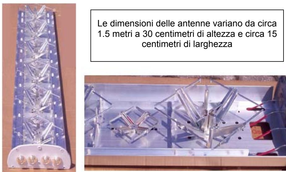
Figura 4: immagini della conformazione interna di una antenna direzionale per SRB
