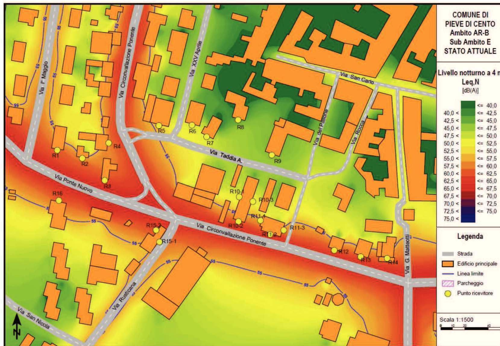
Figura 14– Mappa acustica di isolivello a 4 m dal piano di campagna – STATO ATTUALE PERIODO NOTTURNO
