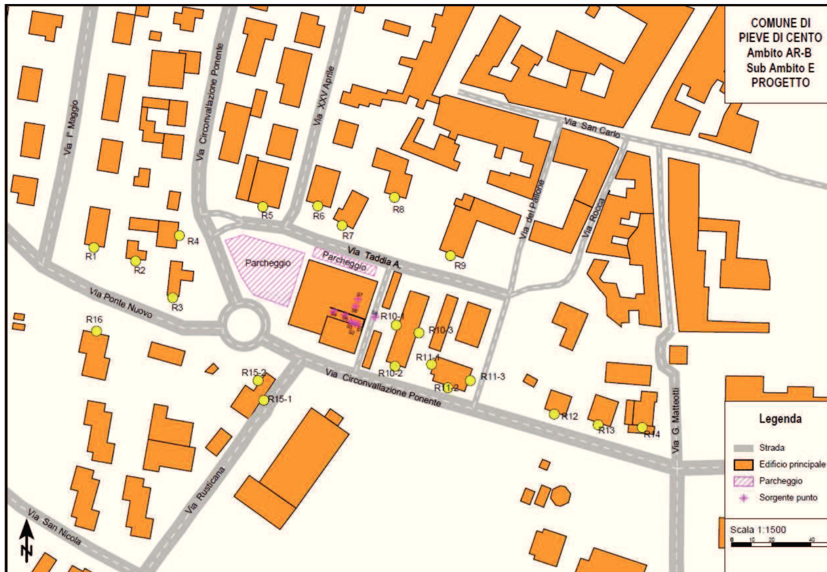
Figura 15 – Planimetria con indicazione dei ricettori sensibili residenziali adiacenti l'area oggetto d'indagine e delle sorgenti sonore di progetto
