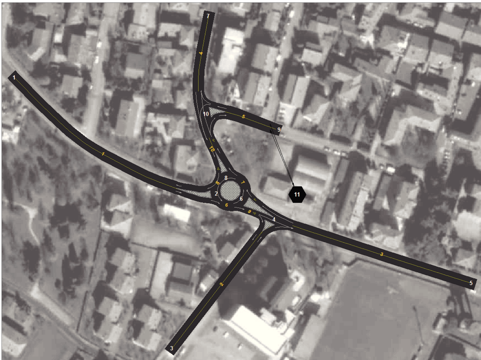
Figura 10-Rappresentazione con microsimulatore di traffico della porzione di rete sottoposta a verifica
