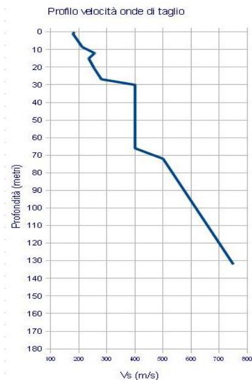
Grafico del profilo di velocità delle onde di taglio desunto dalle indagini. Le velocità sono espresse in metri al secondo
